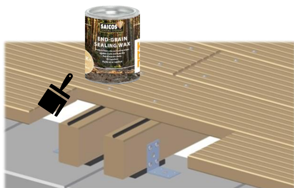
Figure 4 : Le scellement des extrémités avec la cire Kebony End-Grain Sealing Wax est recommandé dans le cadre des meilleures pratiques - cela réduit le risque de fendillement des extrémités.
