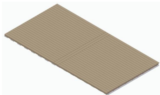
Figure 8 : Exemple d'une terrasse divisée en zones. De telles solutions permettent une utilisation optimale des matériaux et créent un aspect exclusif. Adaptez la taille des zones à la longueur des lames de terrasse.
