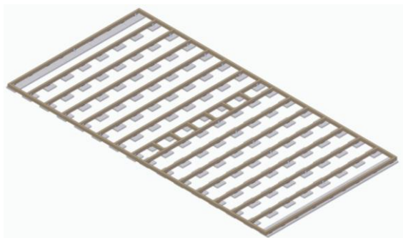
Figure 8 : Exemple d'une terrasse divisée en zones. De telles solutions permettent une utilisation optimale des matériaux et créent un aspect exclusif. Adaptez la taille des zones à la longueur des lames de terrasse.
