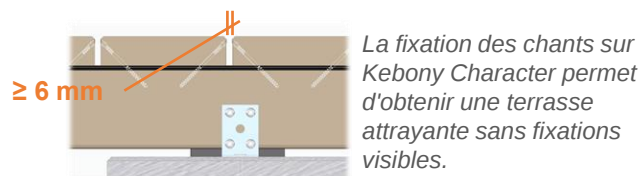
Figure 1 : Fixation des bords de la terrasse Kebony Character Decking
