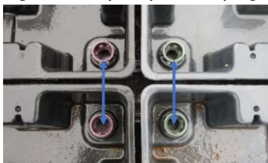
Figure 18. La couleur des manchons des Connecteurs correspond au sens de passage de l'eau
